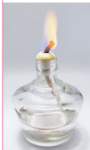
FIG. 2 Combustion complète dans une lampe à alcool.
